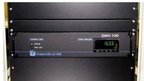
**DMV y DM** - Detector de velocidad y desplazamiento del rotor que detecta y anuncia el movimiento lento del rotor y mide la velocidad de rotación
