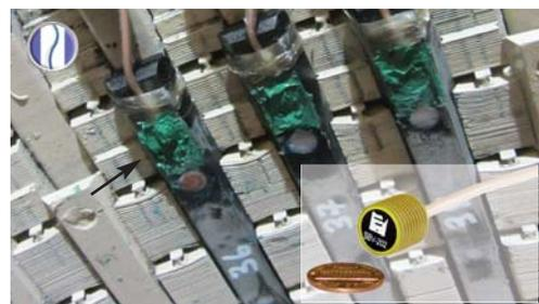
**SBV** - Mide la vibración de la barra dentro de la ranura cuando la máquina está funcionando
