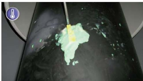
**FOT** - Sensor de temperatura de fibra óptica para el monitoreo de la temperatura de los cabezales de bobina, las barras colectoras de fase aislada, las escobillas del excitador y los interruptores de cuchilla
