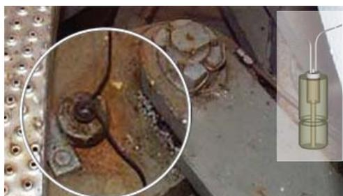
**BSPD** - Detector de pines de seguridad rotos que los identifica y envía una notificación inmediata a un panel de alarma remota
