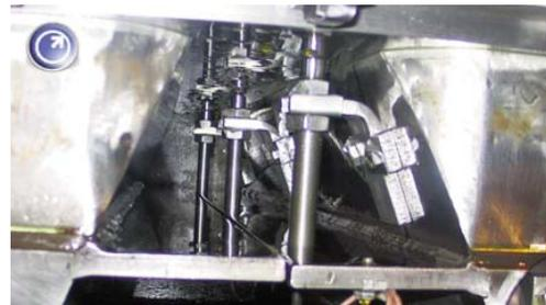
**SPES** - Sonda para el monitoreo del espesor de la película de aceite
