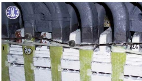
**TWS** - Monitoreo de la temperatura del bobinado y de la pared del núcleo del estator
