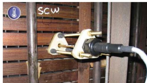
**TWR** - Monitoreo en línea, sin contacto, de la temperatura de la cara de los polos del rotor y del interpolo
