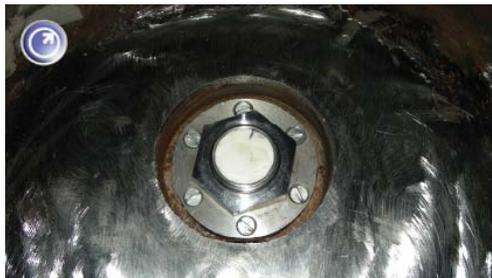
**SPES** - Sonda de proximidad subacuática para para el monitoreo del espacio entre la turbina y la cámara de turbina
