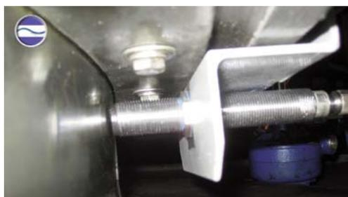
**PCS** - Sonda de proximidad sin contacto para medir la vibración relativa, el desplazamiento radial y el posicionamiento axial
